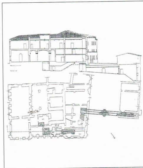
FIG. 19 – Rilievo attuale dei locali interrati sotto il piano terra del Casino, in cui si evidenziano due cisterne tra loro collegate, una scala non più utilizzabile con gradini in pietra e un tunnel che collegava il Casino con le vecchie cucine.
